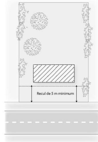
La totalité de la projection verticale (emprise au sol) de la construction principale doit s'implanter avec un retrait minimal de X mètres par rapport à l'alignement, c'est-à-dire la limite entre le domaine privé et public (dans l'exemple > 5 mètres).
