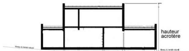
Ne sont pas pris en compte, dans le calcul de la hauteur maximale autorisée, les ouvrages techniques, cheminées et autres superstructures liés aux installations et constructions autorisées dans la zone.
