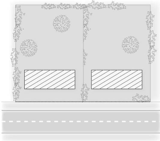
Il est possible d'implanter la construction principale avec le même recul lorsque la construction projetée jouxte une autre construction implantée en retrait de l'alignement, dans la mesure où la continuité et la cohérence de l'alignement sur rue n'est pas rompue.
